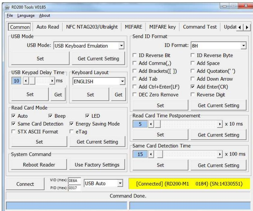
**Onglet Common :** le principal onglet qui permet de paramétrer l'ensemble des fonctions mode clavier écran.
